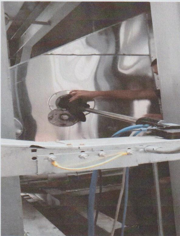
涂装一线 1#RTO 出口净化后有组织现场监测图
